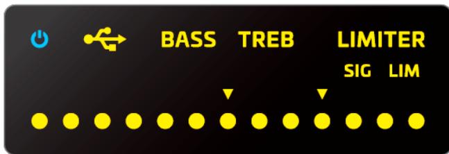
L'écran affiche le paramètre géré par l'encodeur : niveau, panoramique, graves (Bass), aigus (Treb), seuil du limiteur.
